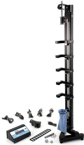
Figura 1: Foto do instrumento de queda livre utilizado para a realização do experimento. Este instrumento é composto por um eletroímã, que segura uma esfera metálica no topo, cinco sensores que acusam a passagem da esfera e um cronometro digital. Foto retirada da referência [2].
